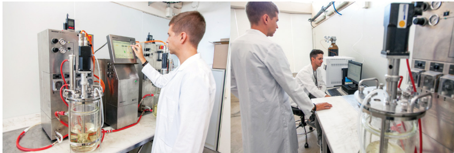
Ilustración 8. Reactores de fermentación (izquierda) y control de biogás (derecha) en las instalaciones de AINIA.
