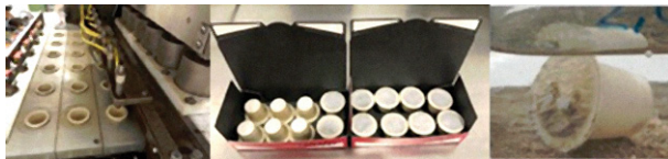
Figura 5. Llenado, estuchado y biodegradación en medio marino de las cápsulas de café. a) Llenado de las cápsulas. b) Estuchado c) Biodegradación en medio marino.
